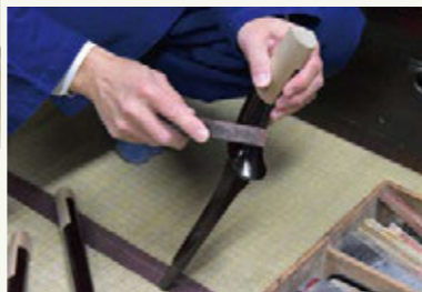
▲のこぎり、ちょうな、かんな、のみ、やすりなどを使って棹を作る。最後は砥石で磨き上げる。
