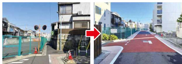
道幅(1.8m～3.5m)が狭く、老朽住宅が密集していましたが、用地買収などを経て6mに道路を拡幅しました。建物倒壊時にも道路がふさがりにくくなり、避難や消火活動をスムーズに行えるようになっています。
