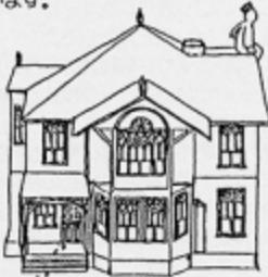
インブリー館の特徴は、下見板張りの外壁、シンプルなアーチ型の窓枠、屋根の軒樋など、19世紀末のニューアークリンド地方の典型的な木造住宅です。カーベンターゴシック様式を用いた柱や、外観では柱と壁を使い分けた日本風の部分も見られるそうです。日本の明治文
