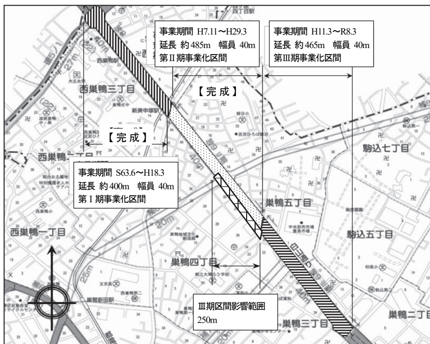
図表 2-2-9 放射9号線平面図
