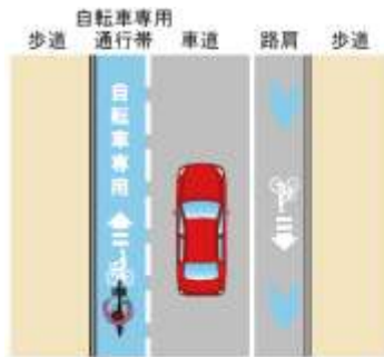
図Ⅱ-9 一方通行道路に自転車専用通行帯を設置する場合の事例
