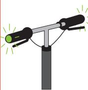
①緑色の最高速度表示灯を点滅させ 時速6km/hモードに切り換える。
